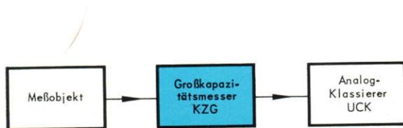
Meßplatz für Handbetrieb (z. B. für Stichproben), bei dem ein Analog-Klassierer die Toleranzklasse des jeweiligen Meßwertes anzeigt und die Häufigkeit jeder Klasse zählt.
